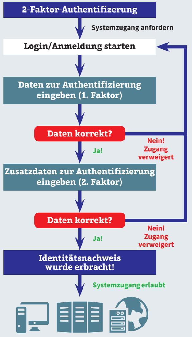
**Schritt für Schritt:** Nur wenn der erste Zugangsfaktor korrekt eingegeben wird, fragt das System den zweiten Faktor ab.
